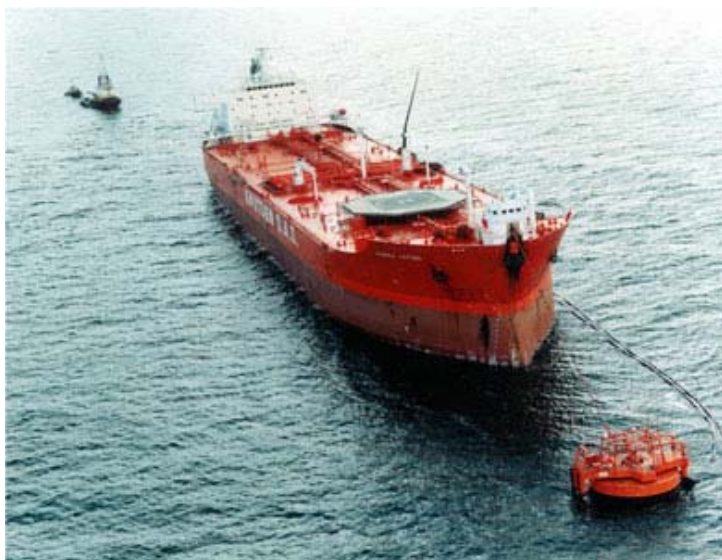
Tankolaivis prie Butingės terminalo prisikabina prie povandeninio naftos vamzdžio (nuotrauka iš www.nafta.lt )
